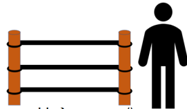
杭とロープ (ロープは複数本設置)
