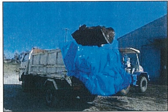
ブルーシートを敷いた深型ダンプ 出典：宮崎県
