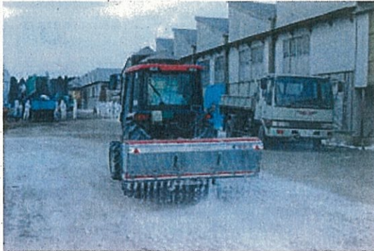
ライムソア(石灰などの粉状の資材を 散布する機械)による消石灰の散布
