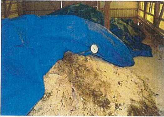
堆肥用温度計を用いて 鶏糞中の温度を測定
