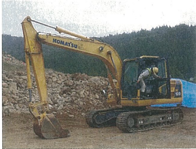
掘削などで使われる油圧ショベル
